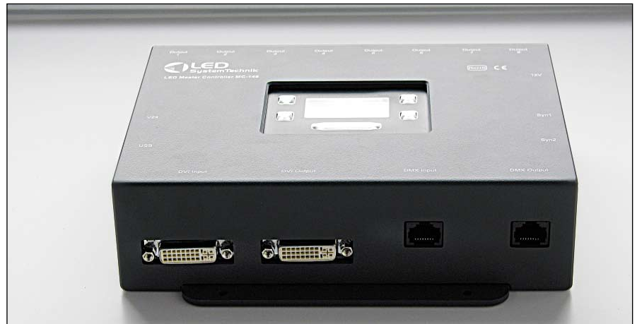
Bild 3: Die Ansteuerelektronik der Videokachel von Comled Project: Entwickelt und gefertigt bei Rowatronic
